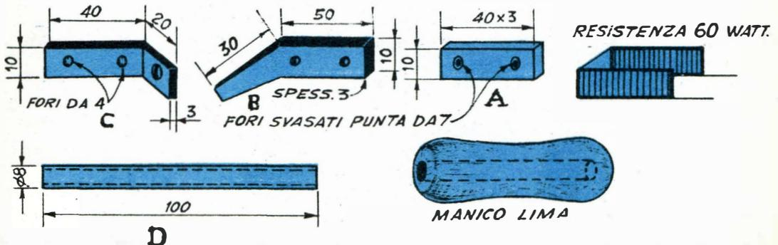
fettuare da un bravo saldatore la saldatura tra una estremità del pezzo D e la porzione da 20 mm. del pezzo B, si passa a controllare che tra le coppie di fori, rispettivamente praticate nei pezzi A, B, C, risultino allineate, in maniera che i buloncini che si dovranno usare per la unione delle tre parti, possano attraversare e sporgere dalla parte opposta, per essere impegnati per mezzo di dadini. Sarebbe bene che sia buloni che dadi fossero di metallo inossidabile.
