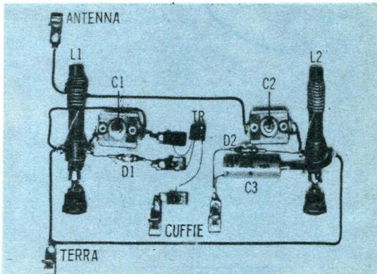
all'antenna, l'altro prosegue ed attraversa un trimmer, ossia un compensatore a mica, di buona qualità, il C2, per giungere direttamente alla bobina dello stadio di utilizzazione della energia delle radioonde, ossia alla L2.
