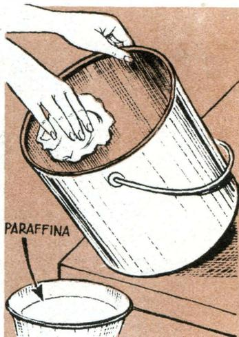
Per tener sempre pulito il secchio della N. U. preservandolo da ogni attacco di ruggine, è veramente utile il noto trattamento della paraffina. Per chi ancora non ne conoscesse il sistema, si consiglia di spalmare l'interno del secchio — se metallico, s'intende — fin da quando è nuovo, con uno straccio imbevuto di paraffina calda. Questo lavoro andrebbe fatto sovente e con maggiore cura nelle piegature.
